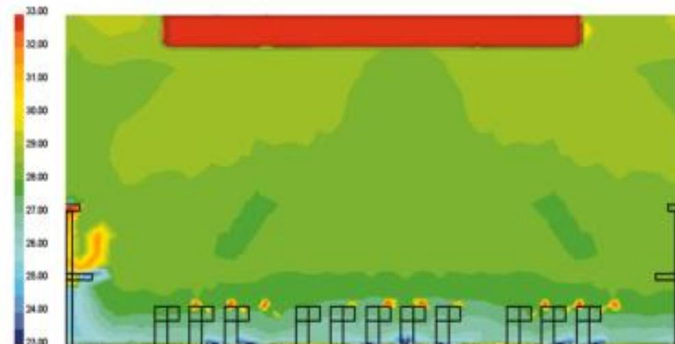
Abb. 1 Gebäudesituation: Temperaturverteilung ohne elektrochrome Verglasung
